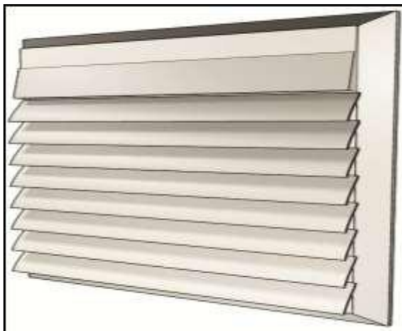
Figura 9 – Grelha de fumaça
