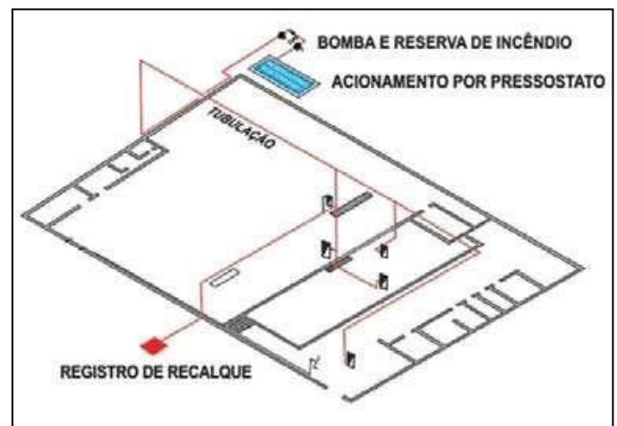
Figura 42 – Isométrica de sistema de hidrantes
