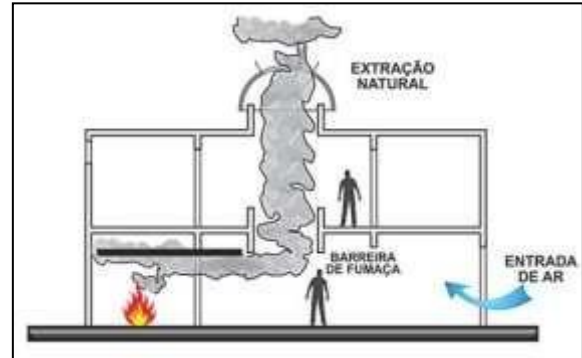
Figura 11 – Extração de fumaça de átrios
