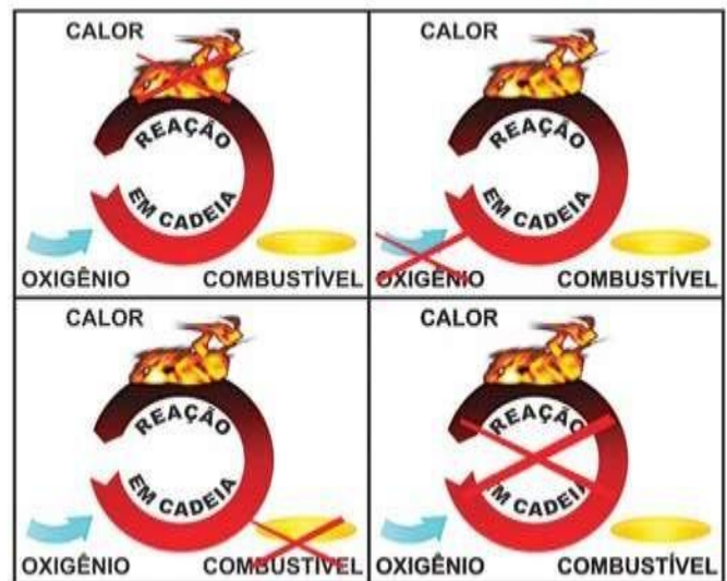
Figura 2 – Mecanismo de extinção do fogo
