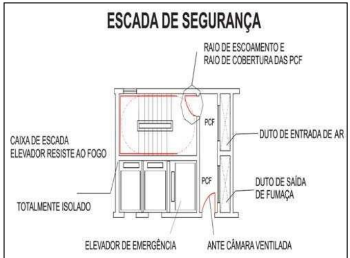
Figura 28 – Escada e elevador à prova de fumaça
