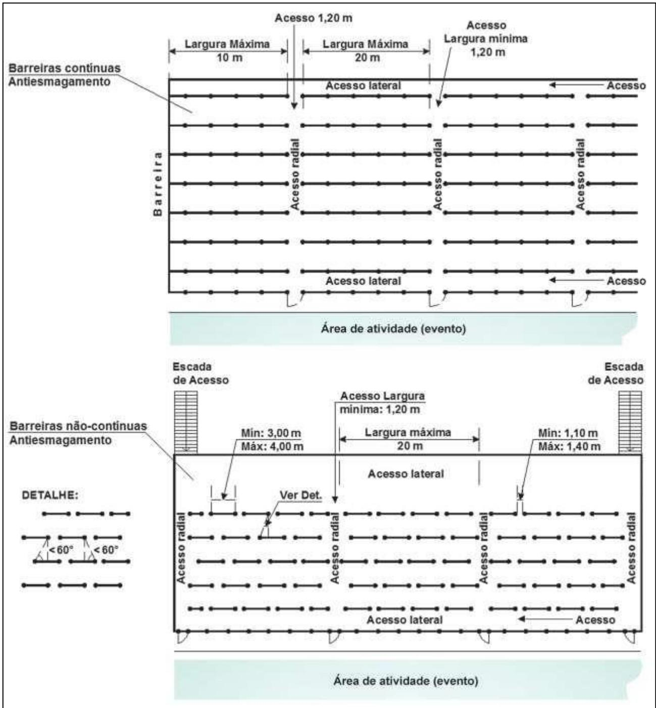
Figura 10 – Barreiras antiesmagamento – contínuas e não contínuas
