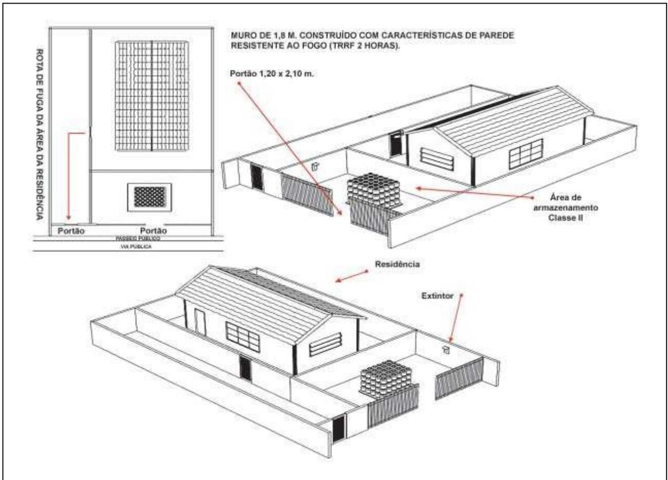
Figura 4 – Afastamentos para revendedor classe II e residência com entrada independente
