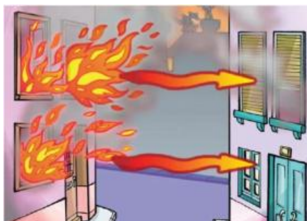
Figura 8 - Radiação de calor de um edifício para o outro (Fonte: Escola Nacional de Bombeiros, Fenomenologia da Combustão e extintores, Volume VII)
