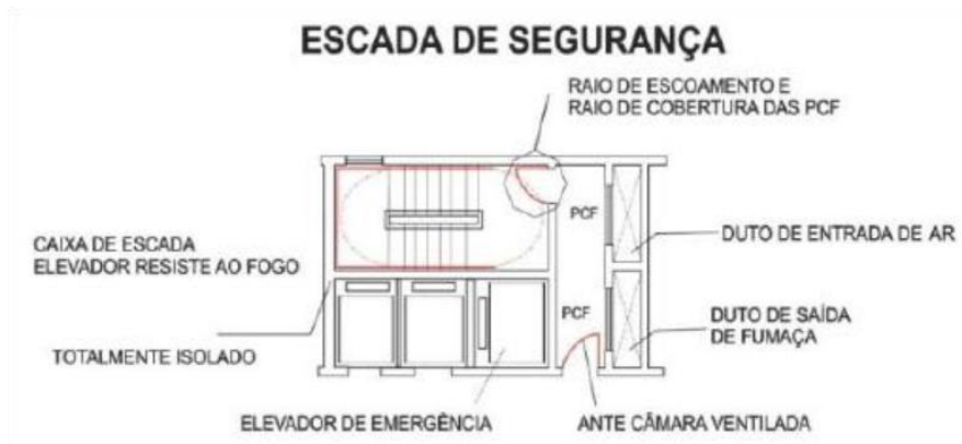
Figura 27 - Escada e elevador à prova de fumaça
