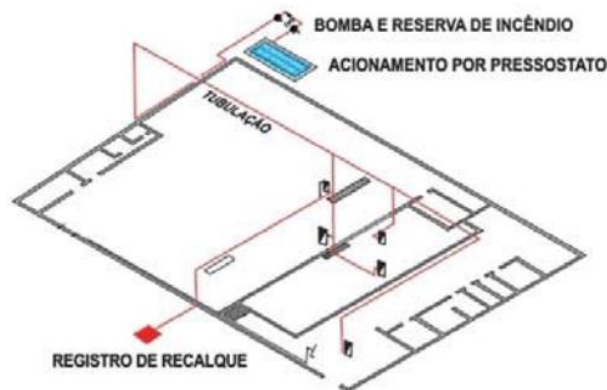
Figura 40 - Isométrica de sistema de hidrantes
