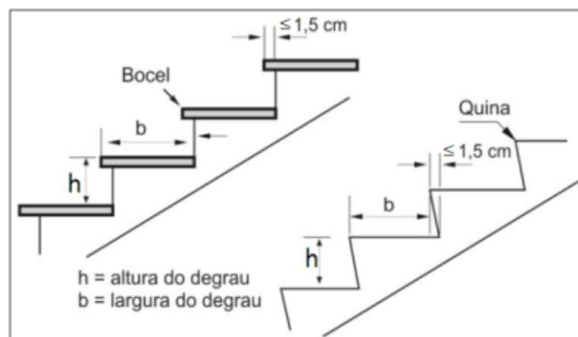
Figura 4 - Altura e largura dos degraus
