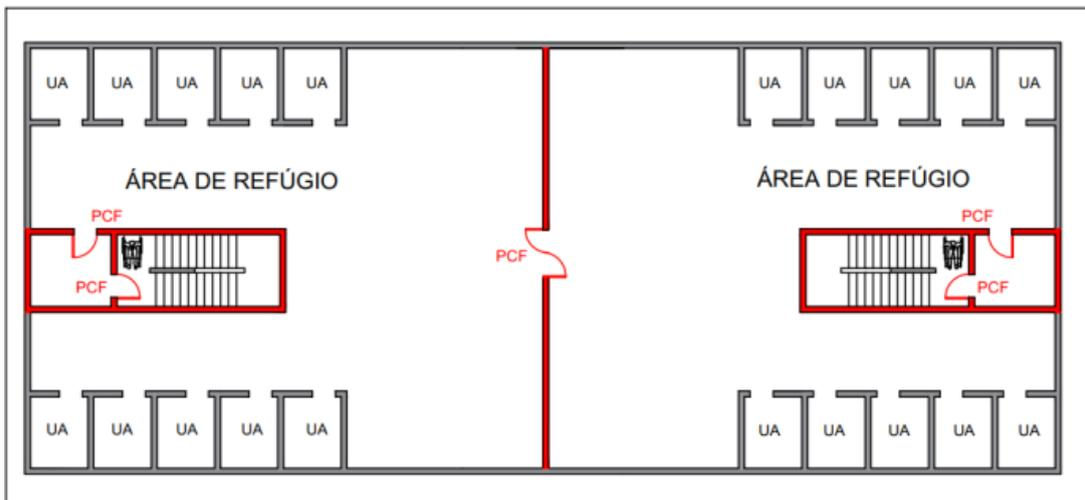
**Figura 19** - Exemplos esquemáticos de áreas de refúgio (Ilustrativo)
