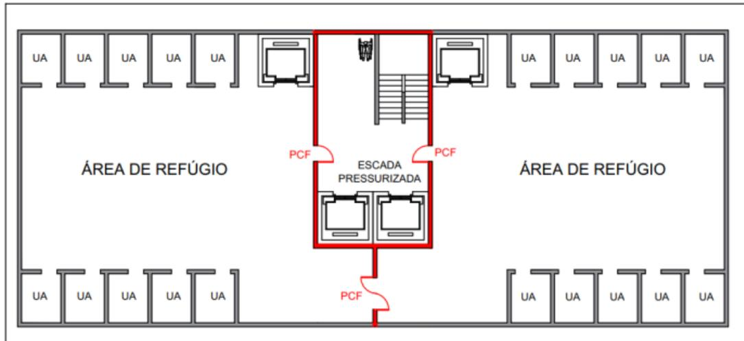
**Figura 18** - Exemplos esquemáticos de áreas de refúgio (Ilustrativo)
