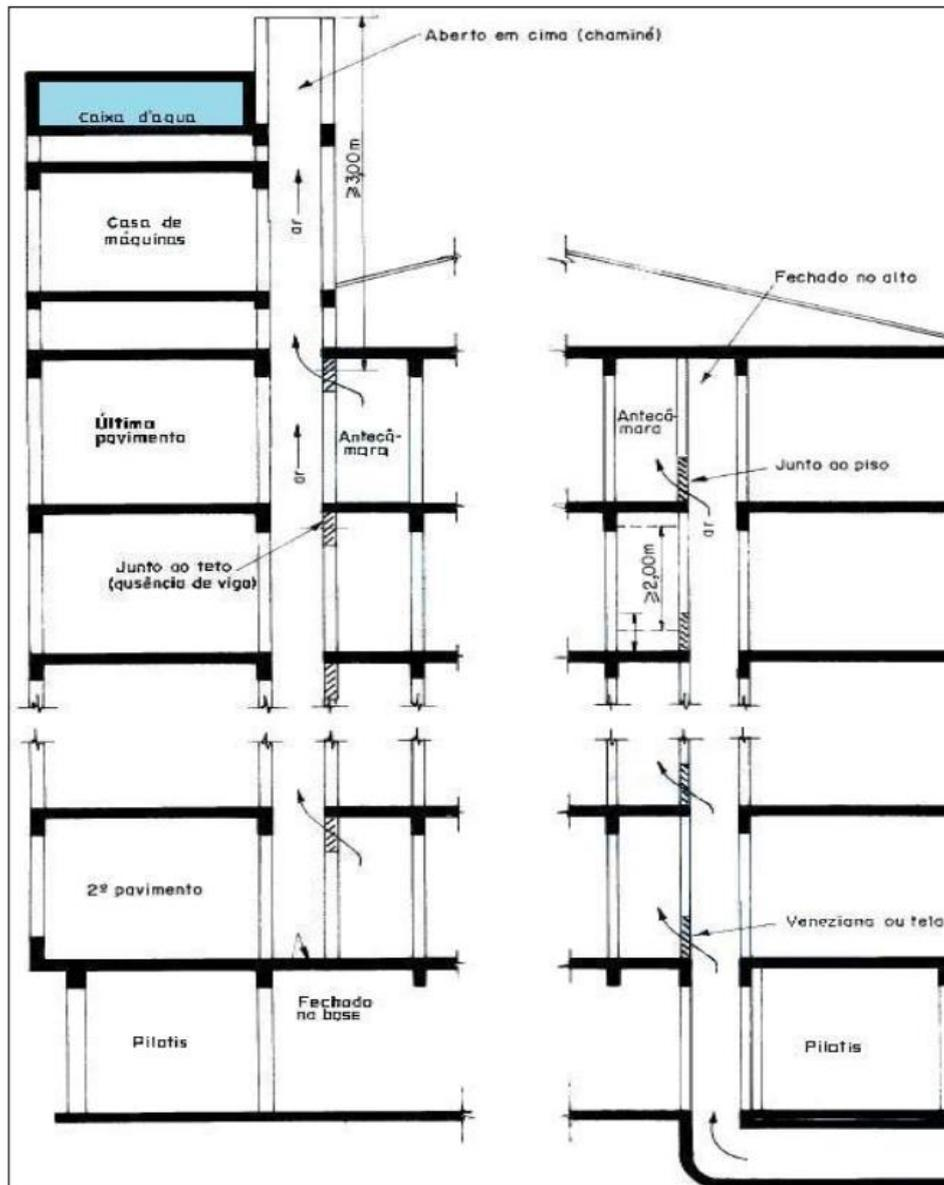
Figura 10 - Exemplo de dutos de ventilação (corte AB e corte CD)
