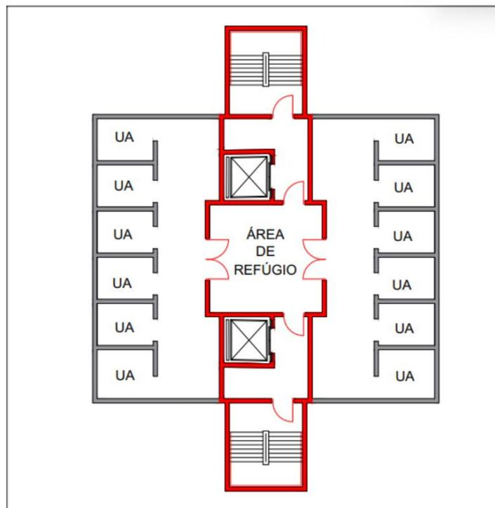
**Figura 17** - Exemplos esquemáticos de áreas de refúgio (Ilustrativo)
