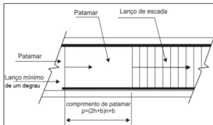
**Figura 5** - Lanço mínimo e comprimento do patamar
