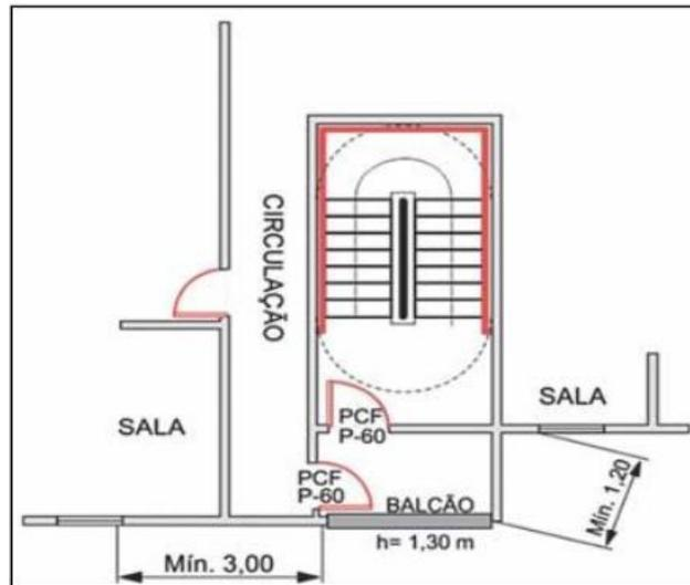
**Figura 11** - Escada enclausurada ventilada por balcão
