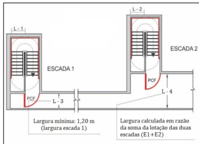
**Figura 20** - Dimensionamento de corredores de descarga
