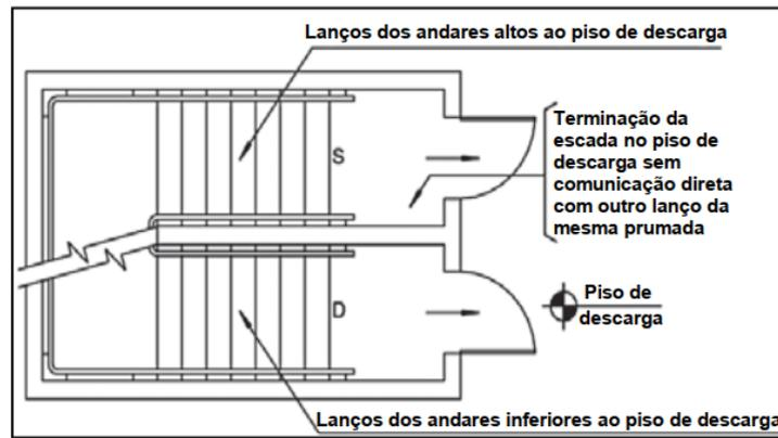
Figura 3 - Segmentação das escadas no piso da descarga
