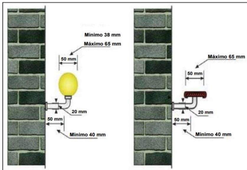
**Figura 15** - Dimensões de guardas e corrimãos
