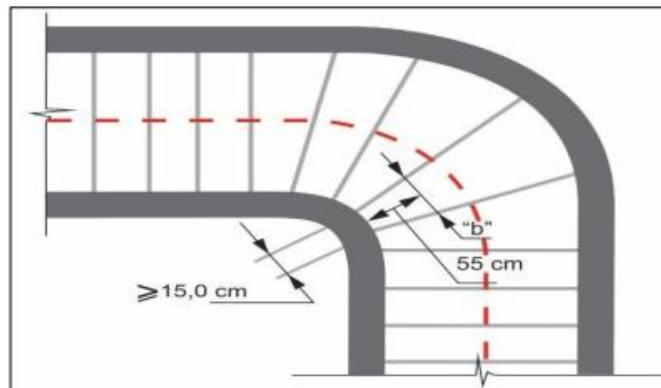
Figura 6 - Escada com lanços curvos e degraus balanceados
