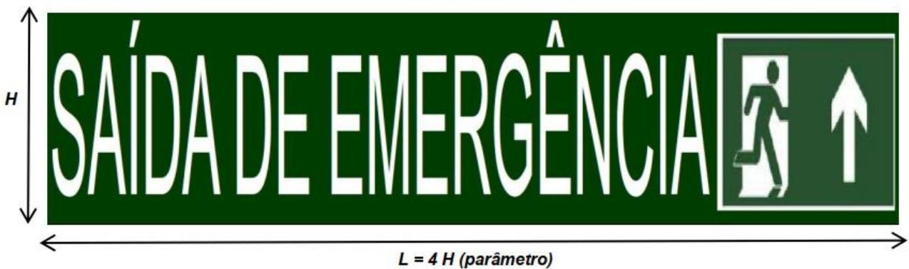
**Figura 1 do Anexo B** - Exemplo de faixa de sinalização de emergência com funo verde e letras brancas
