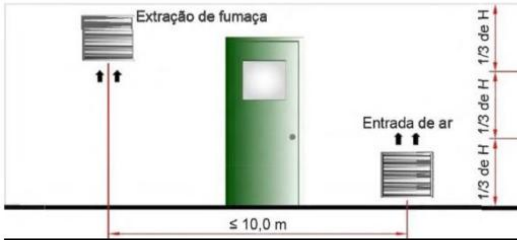
Figura 21 - Posição de aberturas de extração e introdução de ar
