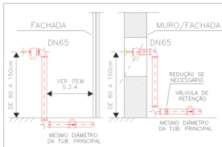
**Figura 1** - Dispositivo de recalque tipo coluna
