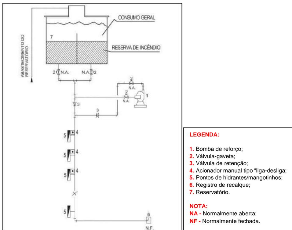
**Figura C.5** – Esquema de instalação de bomba de reforço abastecendo os pontos de hidrantes mangotinhos mais desfavoráveis considerados no cálculo, por uma só prumada
