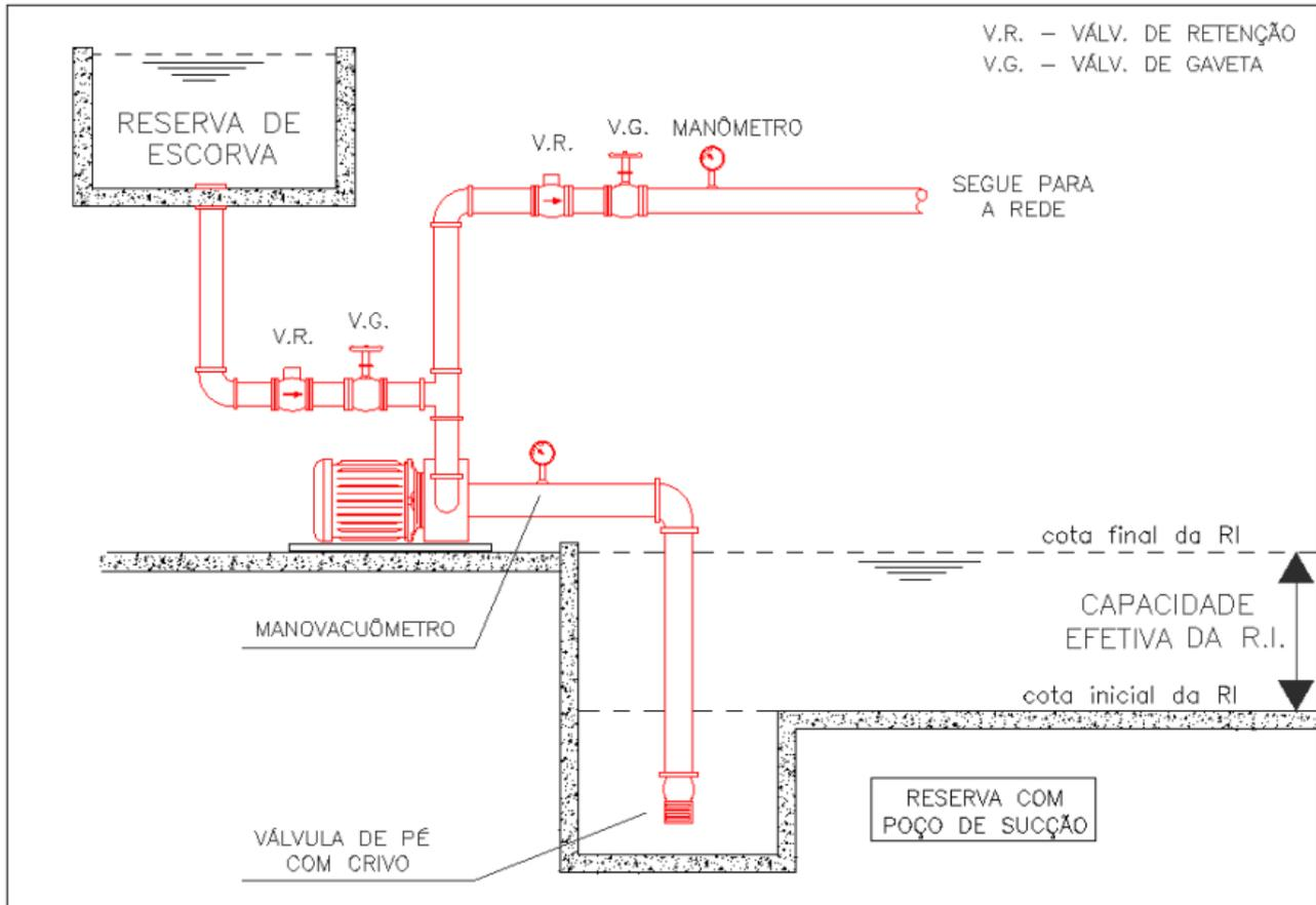
VR - Válvula de retenção VP - Válvula de paragem
