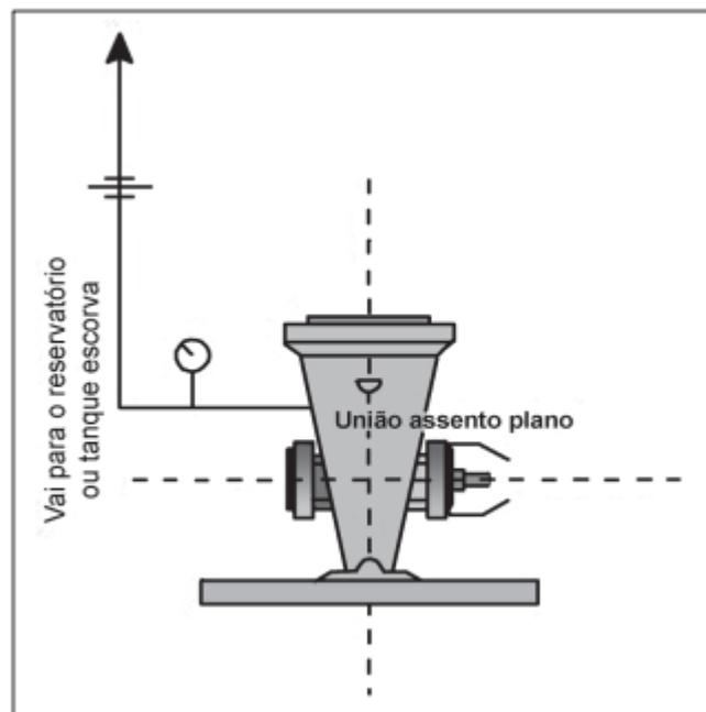
**Figura C.7** – Arrefecimento da bomba principal elétrica
