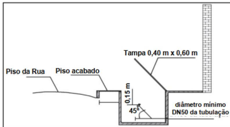
**Figura 2** - Dispositivo de recalque no passeio público
