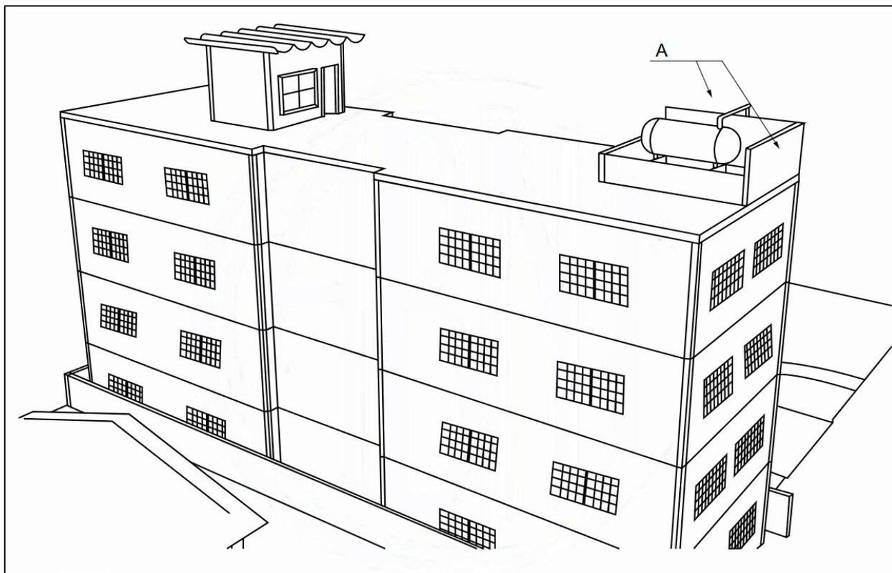
**NOTA:****A** – Parede resistente ao fogo
