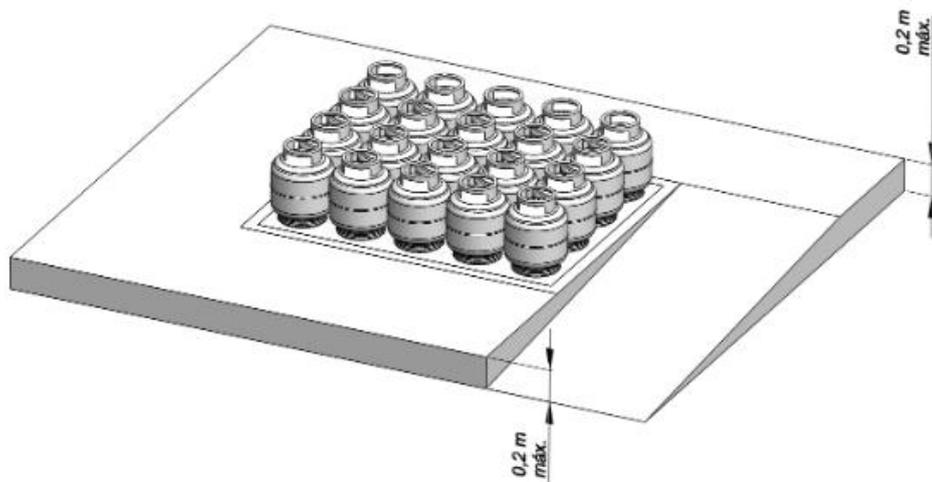
**Figura 2** - Exemplo de Área de Armazenamento com Corredor de Circulação Inclinado
