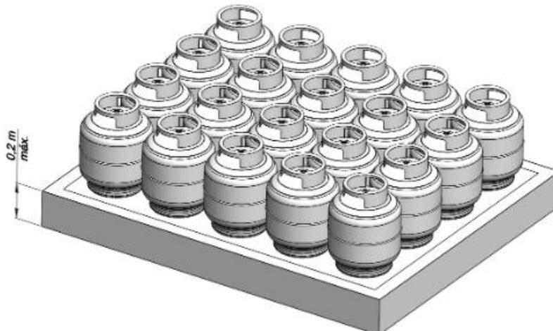
**Figura 3** - Exemplo de Área de Armazenamento com Piso Elevado sem Corredor de Circulação
