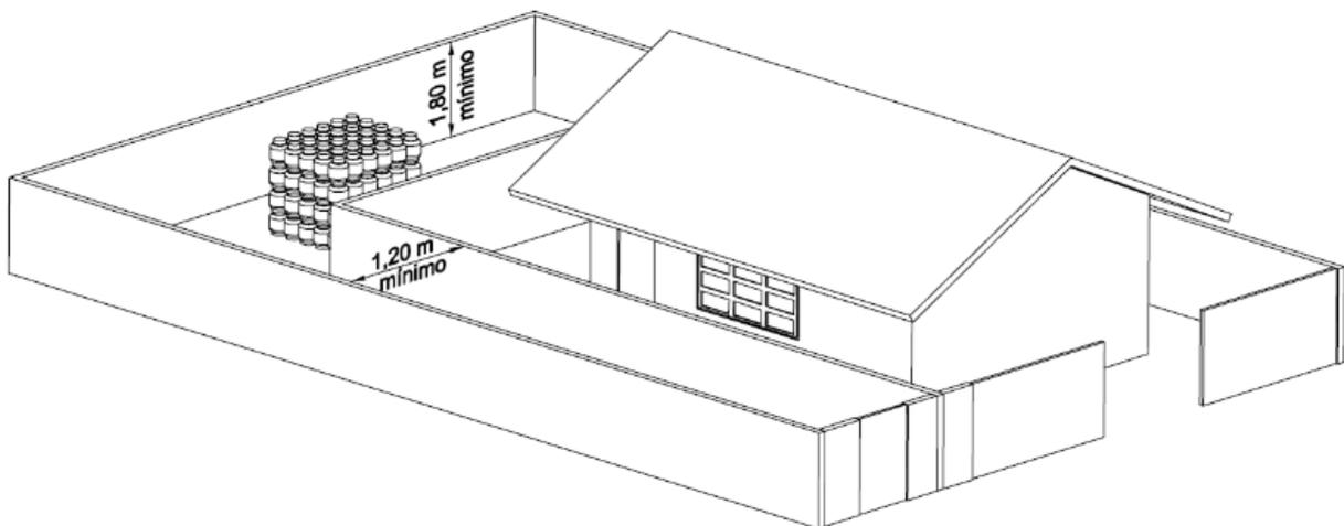
**Figura 6** - Exemplo de Imóvel com Área de Armazenamento de Recipientes Transportáveis de GLP e Residência à Frente do Lote
