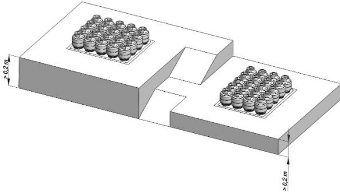
**Figura 4** - Área de armazenamento com diferença de nível maior que 0,2 m e corredor de circulação no piso elevado
