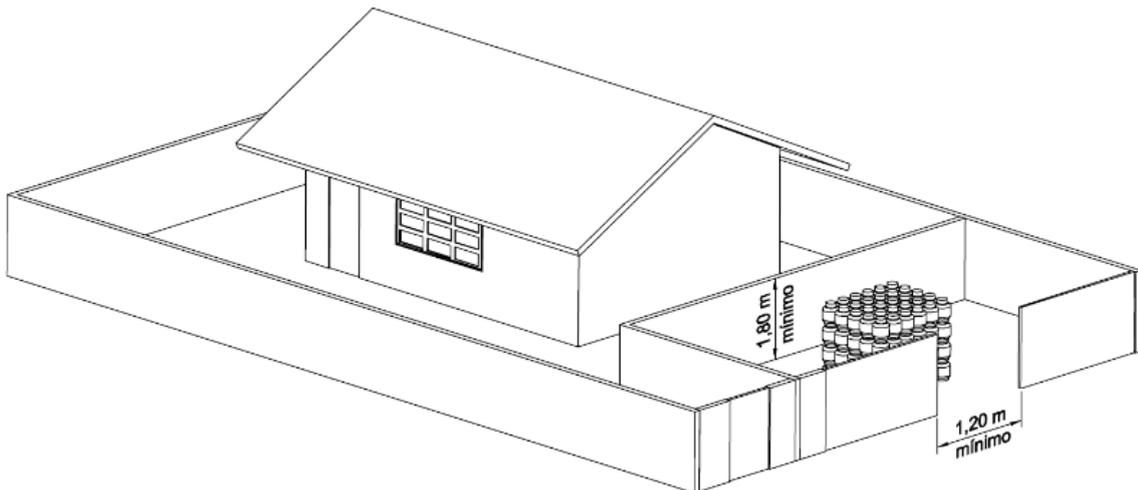
**Figura 5** - Exemplo de Imóvel com Área de Armazenamento de Recipientes Transportáveis de GLP e Residência aos Fundos do Lote
